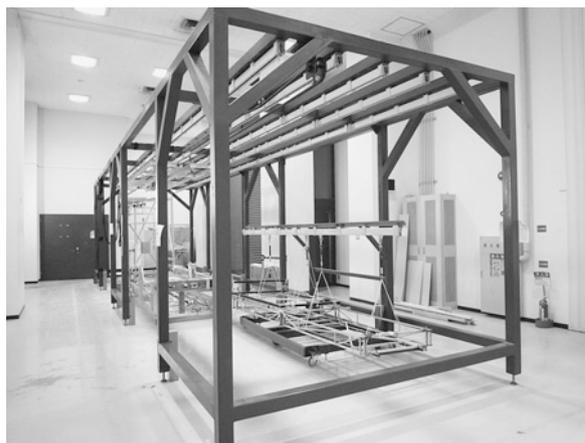
宇宙でパネルを組み立てる機械の実験
